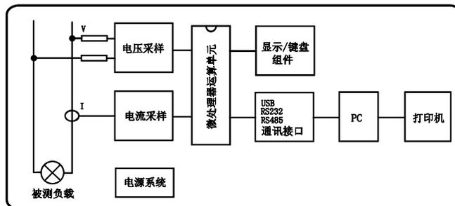
整机由电压/电流采样电路、微处理器运算电路、USB/RS485通讯电路、PC端软件、电源电路组成。
