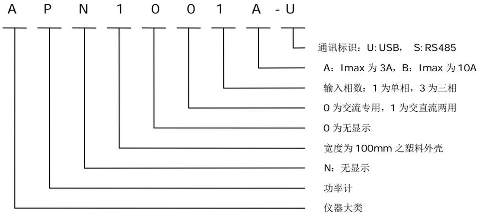
目前 APN1001 系列功率分析仪为单相便携式功率分析仪。按最大输入电流量程分为 A: 最大量程为 3A, B: 最大量程为 10A, A 形功率分析仪在测量小功率之负载具有良好的分辨率。最后一位标识是带通讯的识别码, U:USB, S:RS485, 如: APN1001A-U 为 USB 接口的机型, 具有快速的通讯速度, 较适宜于实时测量。APN1001A-S 为 RS485 接口的机型, 较适宜用于自动化控制、电力监控等应用。
