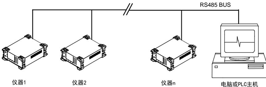
RS-485一般只需二根联机，所以RS485接口均采用屏蔽双绞线传输。本仪器的RS485采用半双工通信。采用三个接线端子，两条信号线：A+ 和B-，一条屏蔽线COM。两条信号线必须与主机的RS485接口正确连接。若有多台仪器组成网络，采用并联的方式将信号线和主机连接。
